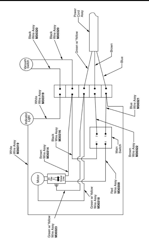
Wiring Diagram 220/240V
