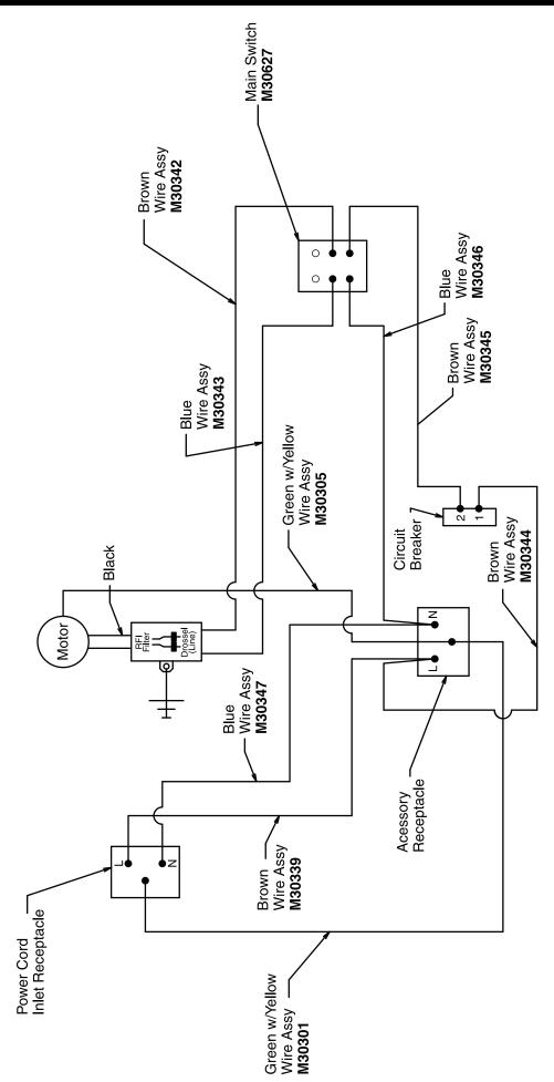
Wiring Diagram 220/240V
